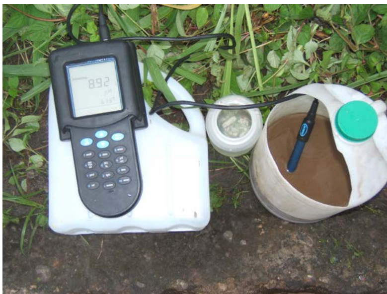
Fotografía No. 9. Utilización de equipo Hatch en medición de muestras in-situ. (Fuente: Gustavo Viteri, 11/01/2005)
