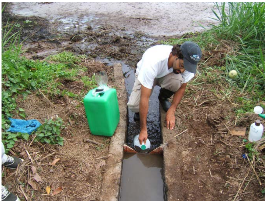
Fotografía No. 8. Recolección de muestras en canal de descarga con vertedero triangular de 90° y flujo en régimen laminar. (Fuente: Gustavo Viteri, 11/01/2005)
